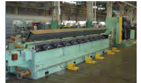
銅線用荒引伸線機 LLA-11V(焼鈍機付)
