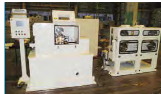
C-20型螺旋コルゲート管製造装置 (キャタピラー式引取機、コルゲート装置)
