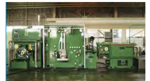
錫メッキ銅平角線用伸線機・焼鈍・巻取機(高速型) M13+HE100+AF0+D5B型
